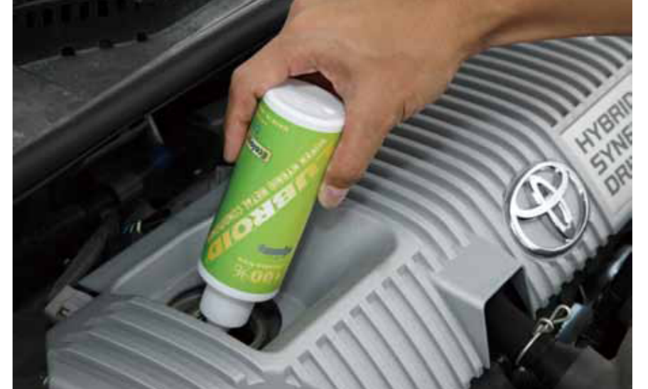
↑エンジンを少し冷やし、オイルフィルターから直接ルブロイドを注入。添加量はエンジンオイルの3%。注入したらアイドリングを行う。
