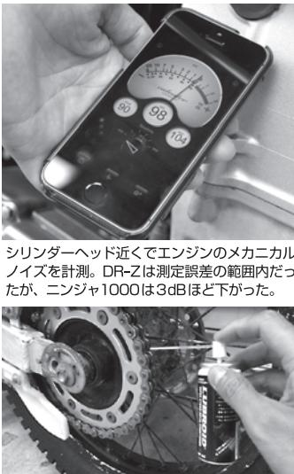
シリンダーヘッド近くでエンジンのメカニカルノイズを計測。DR-Zは測定誤差の範囲内だったが、ニンジャ1000は3dBほど下がった。
