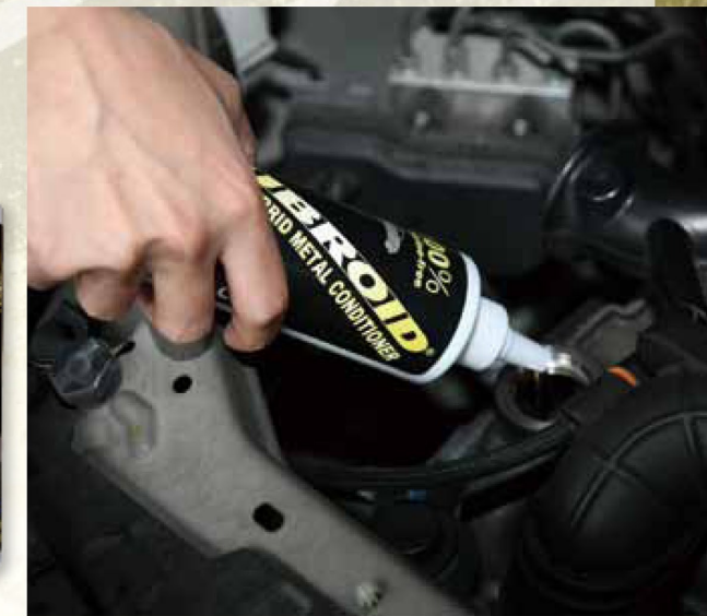
↑エンジンオイル量に対して5~6%のルブロイドを添加する。K6Aのエンジンオイルは3ℓなので、オイルフィルターから150~180mlを注入。
