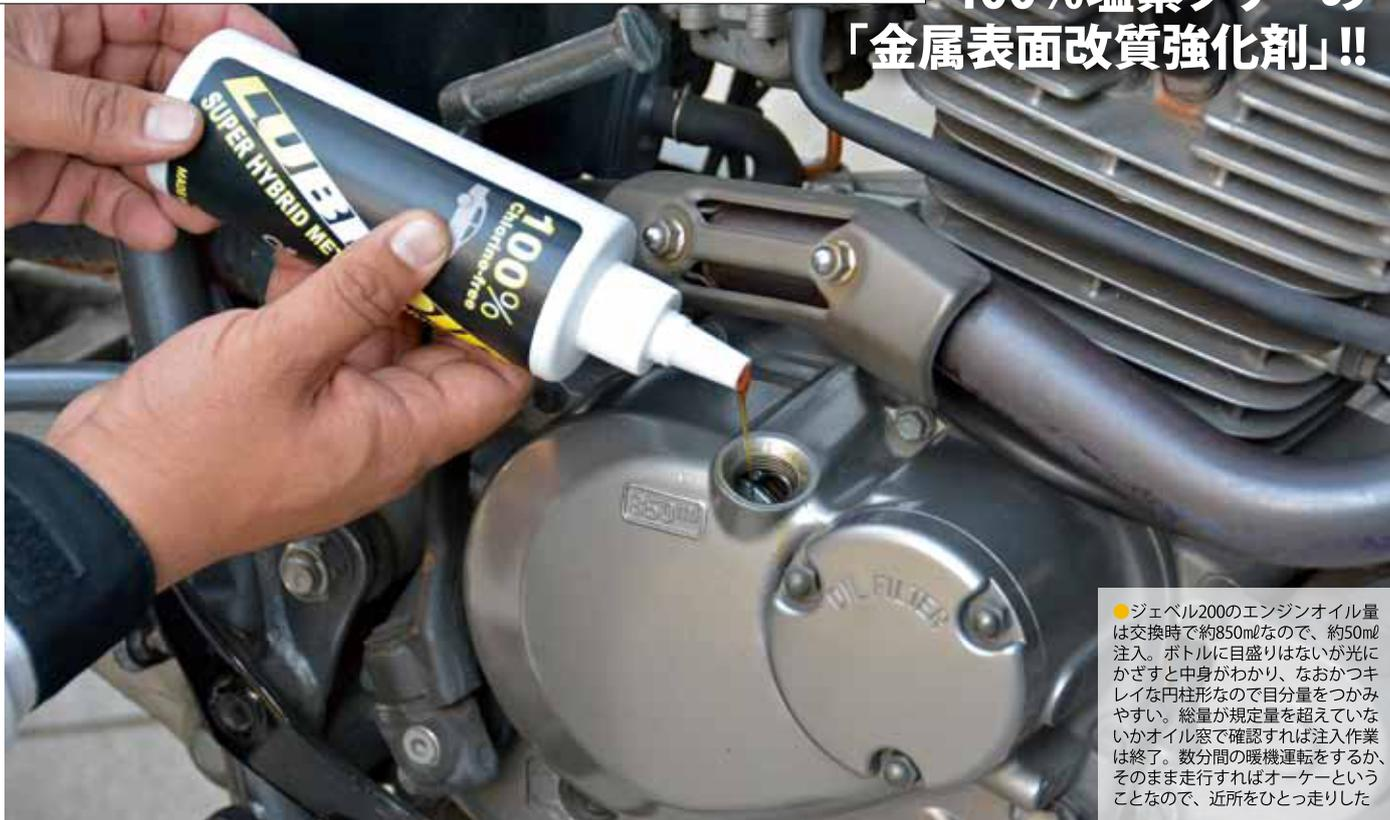
●ジェベル200のエンジンオイル量は交換時で約850mlなので、約50ml注入。ボトルに目盛りはないが光にかざすと中身がわかり、なおかつキレイな円柱形なので目分量をつかみやすい。総量が規定量を超えていないかオイル窓で確認すれば注入作業は終了。数分間の暖機運転をするか、そのまま走行すればオーケーということなので、近所をひと走りした
