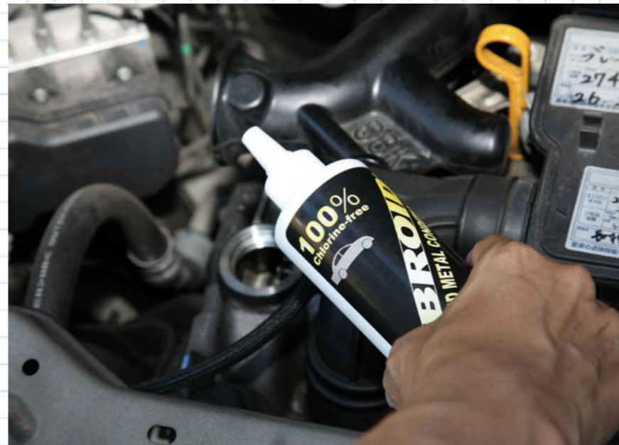
エンジンオイルに対して5~6%のルブロイドを添加する。K6Aのエンジンオイルは3ℓなので、150~180mlを注入する。
