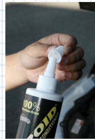
エンジンオイルに対して5~6%のルブロイドを添加する。K6Aのエンジンオイルは3ℓなので、150~180mlを注入する。
